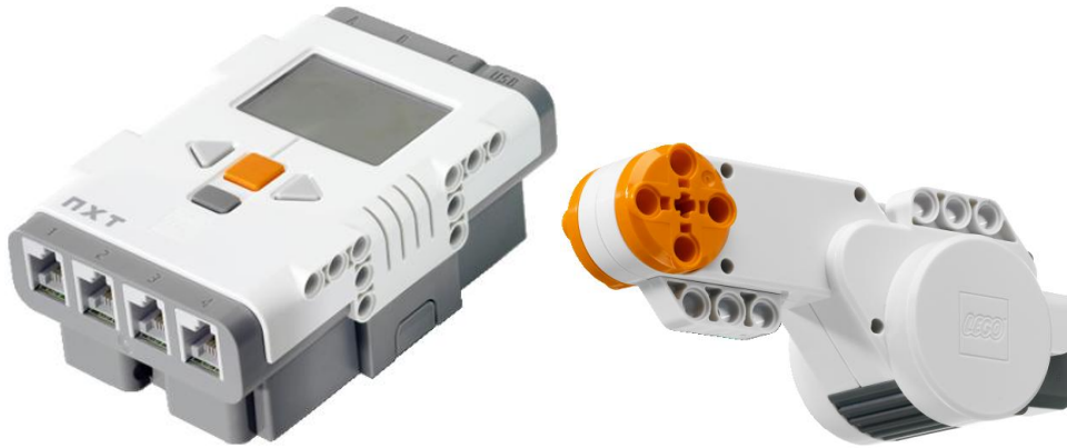
Obrázok 2: Detailný pohľad na inteligentnú kocku a servopohon. [1]
